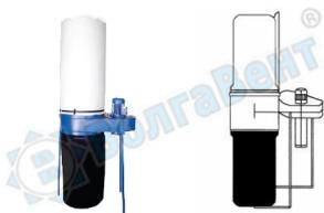
Установки серии «УВП-А» предназначены для удаления и очистки воздуха от абразивной пыли, образующейся при работе заточных, отрезных, шлифовальных станков. Степень очистки воздуха установками серии «А» составляет 99,9%.
